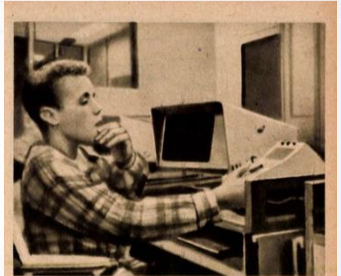
1. ábra. Tanítógép segítségével tanuló diákok. A magyarázat és a kérdések a diafilmvetítő ernyőjén jelennek meg. A tanuló a jobb oldali kis vezérlőpulton levő gombok segítségével érintkezik a géppel. (Az elektronikus számítógép a képen nem látható.)
